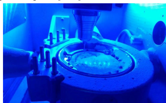
Fig.2. Zirconia blank milling
